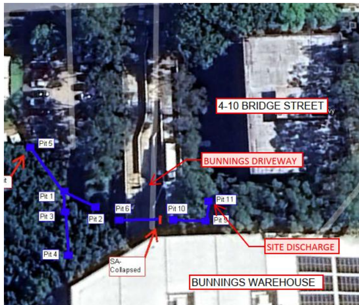
Figure 1 – CCTV Aerial Layout Plan (210817 – ALS CCTV Report)
